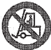
Vietato ai carrelli di movimentazione
