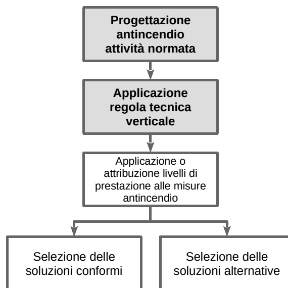
Illustrazione G 2.3: Progettazione antincendio delle attività normate
