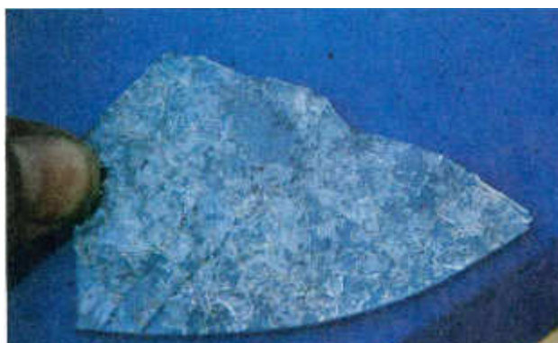
Cavillature causate da un getto d'acqua che colpisce un vetro già esposto al calore.
