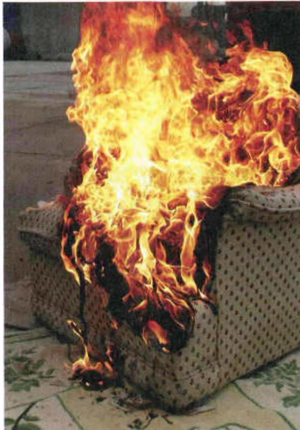
Mentre brucia, la tappezzeria sintetica si scioglie. Gocce incendiate accendono sotto il tappeto e la porzione inferiore del rivestimento della faccia verticale.
