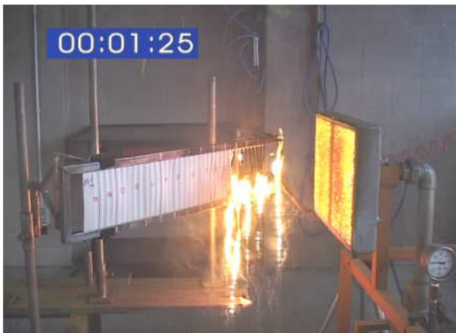
Foto NIA – Prova di reazione al fuoco al pannello radiante “effetto gocciolamento di materiali termoplastici”.
