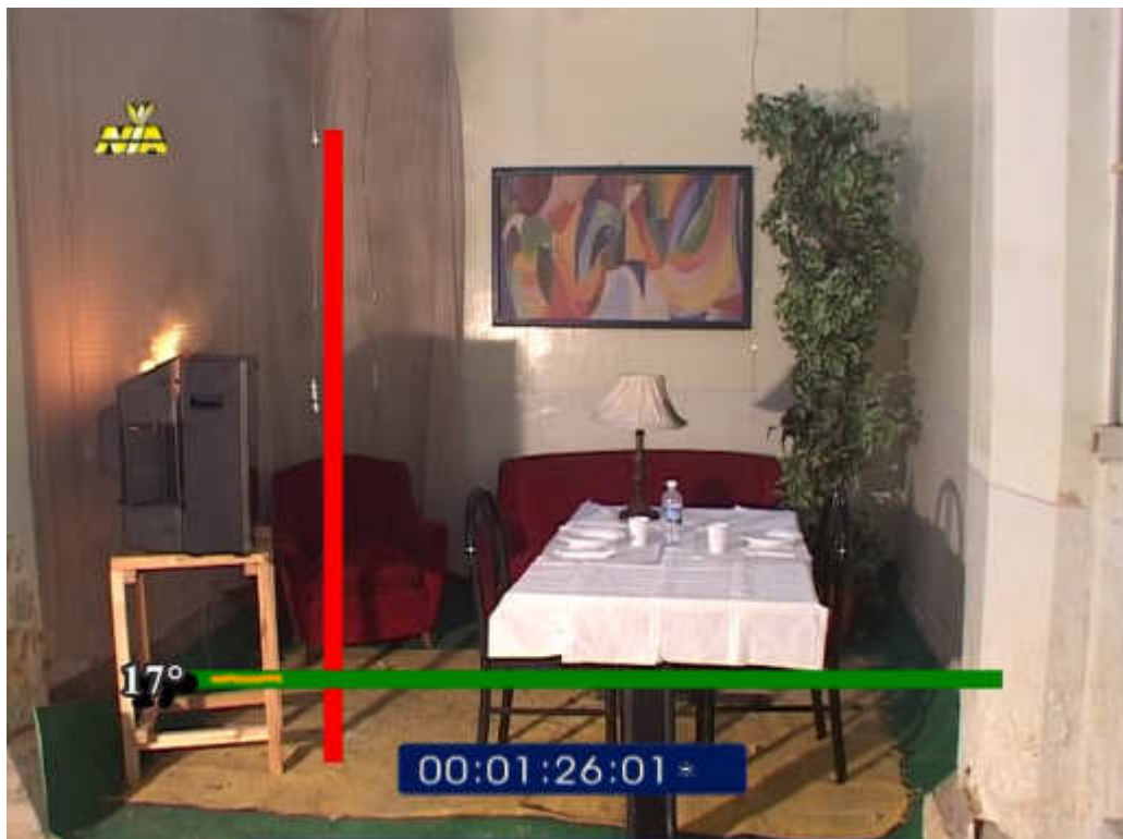
Incendio sperimentale presso il laboratorio del NIA – fase d’ignizione
