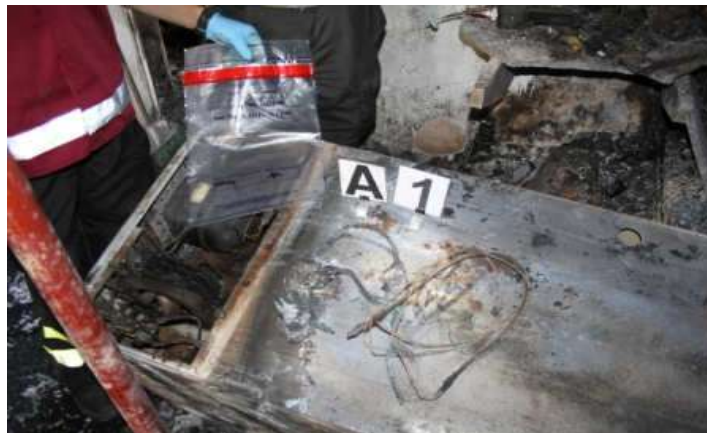
Porzione di corda di alimentazione del frigorifero, repertata da personale del NIA
