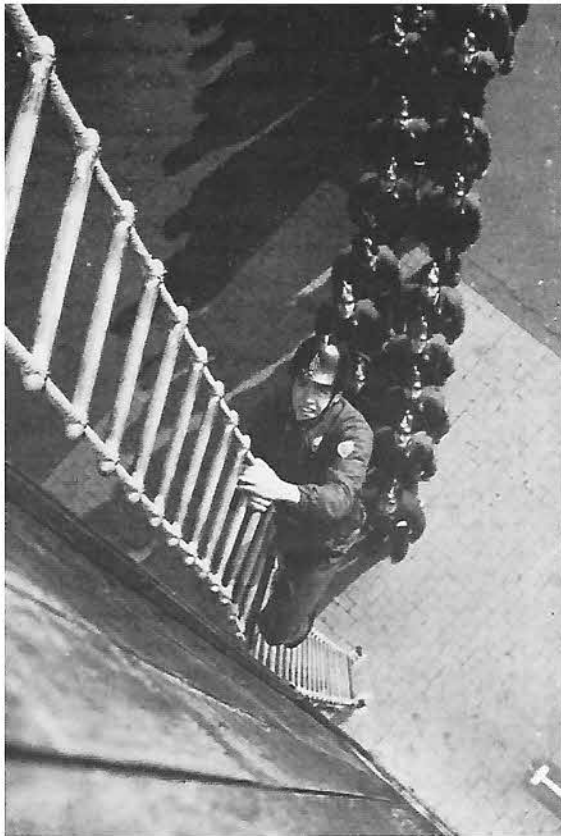
Esercitazioni con scala mista Costituita con pioli in legno e funi di canapa, si presta ad operazioni di salvataggio nelle quali si rende impossibile l'uso delle altre scale. (pozzi, cortili ciechi, ecc.).
